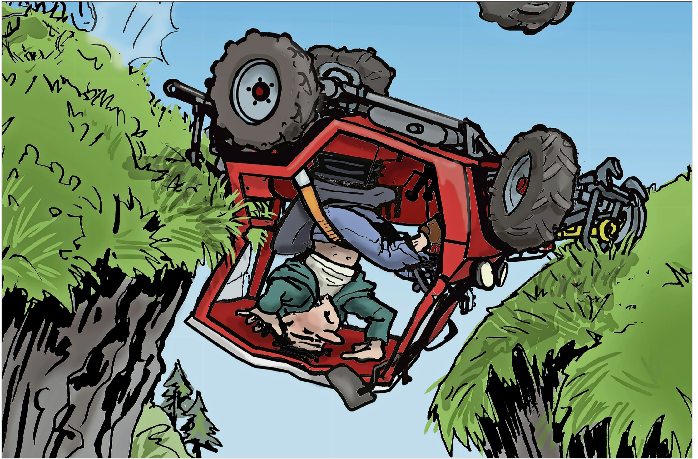
Der Sicherheitsgurt ist dazu da, die lenkende Person im Sicherheitsbereich des Fahrerschutzes der Kabine zu halten. (Bild: bul)
