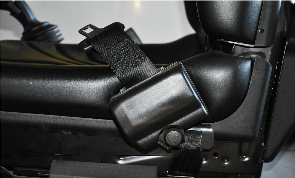
ELR-Retraktoren müssen aufgrund ihrer Sensoren genau im vorgeschriebenen Winkel montiert werden, erlauben dann aber viel Bewegungsfreiheit (Bild: BUL)
