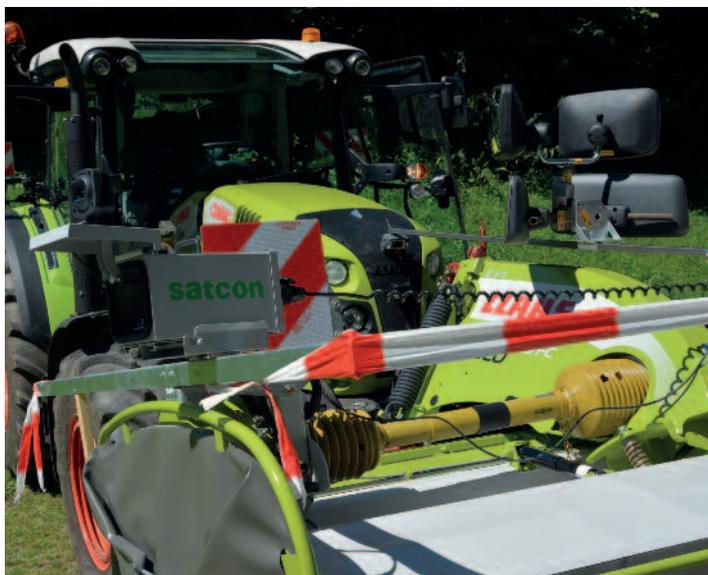
Im Auftrag des ASTRA durfte die BUL eine Untersuchung zum vorderen Überhang durchführen. Es zeigte sich, dass mit Seitenblickkameras Lösungen möglich sind und dass es mit Seitenblickspiegeln schwierig wird. Ein Problem bleibt die Überlastung der Vorderachse.
