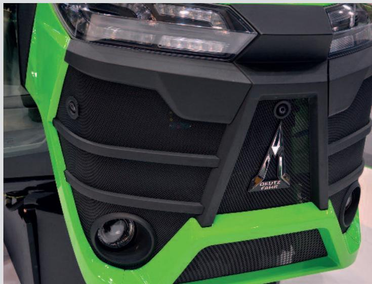
Elektronik soll zu mehr Sicherheit beitragen. An der Agritechnica zeigte Deutz einen Traktor mit Front- und Seitenkameras, der Personen erkennen soll und nicht wegfahren kann, wenn sich jemand in gefährlicher Nähe aufhält.
