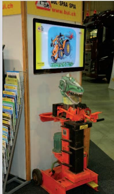
Für die Forstmesse und weitere Ausstellungen wurde eine manipulierte Zweihandholzsplattmaschine zum Krokodil mit Fussbedienung umgebaut. So konnte die Gefahr wirksam gezeigt werden.
