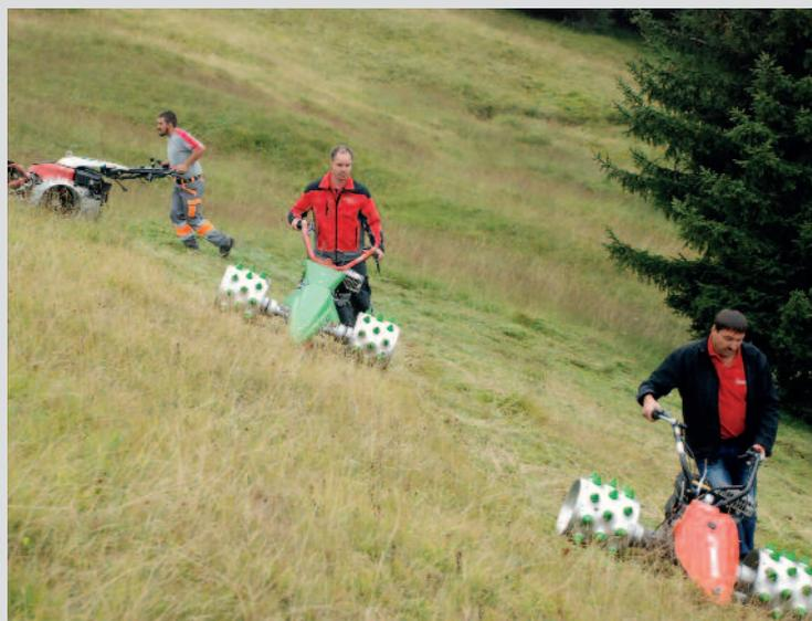
Handgeführte Motormäher werden mit entsprechender Ausrüstung immer geländegängiger. Was noch zu wenig bekannt ist, dass sich auch die Bedienungsperson mit entsprechendem Schuhwerk ausrüsten muss, z.B. mit Steigeisen.
