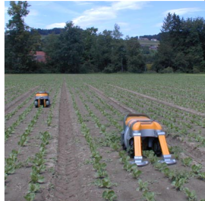
Projektstudie ‚Weedmaster‘: Vollautomatischer Unkrautbekämpfungsroboter für Reihenkulturen (F. Zimmerli, 2003).
