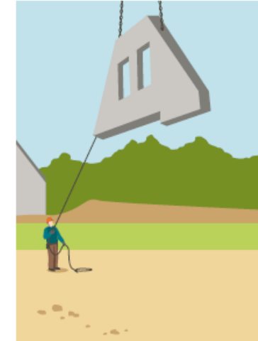
2 Last mit Führungsleine führen.
