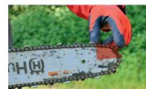
Das Sägen mit dem vorderen oberen Teil der Schwertschulter sollte nach Möglichkeit vermieden werden.
