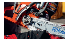
Die Fasern von Schnittschutzhosen in PSA bremsen die Sägekette umgehend.
