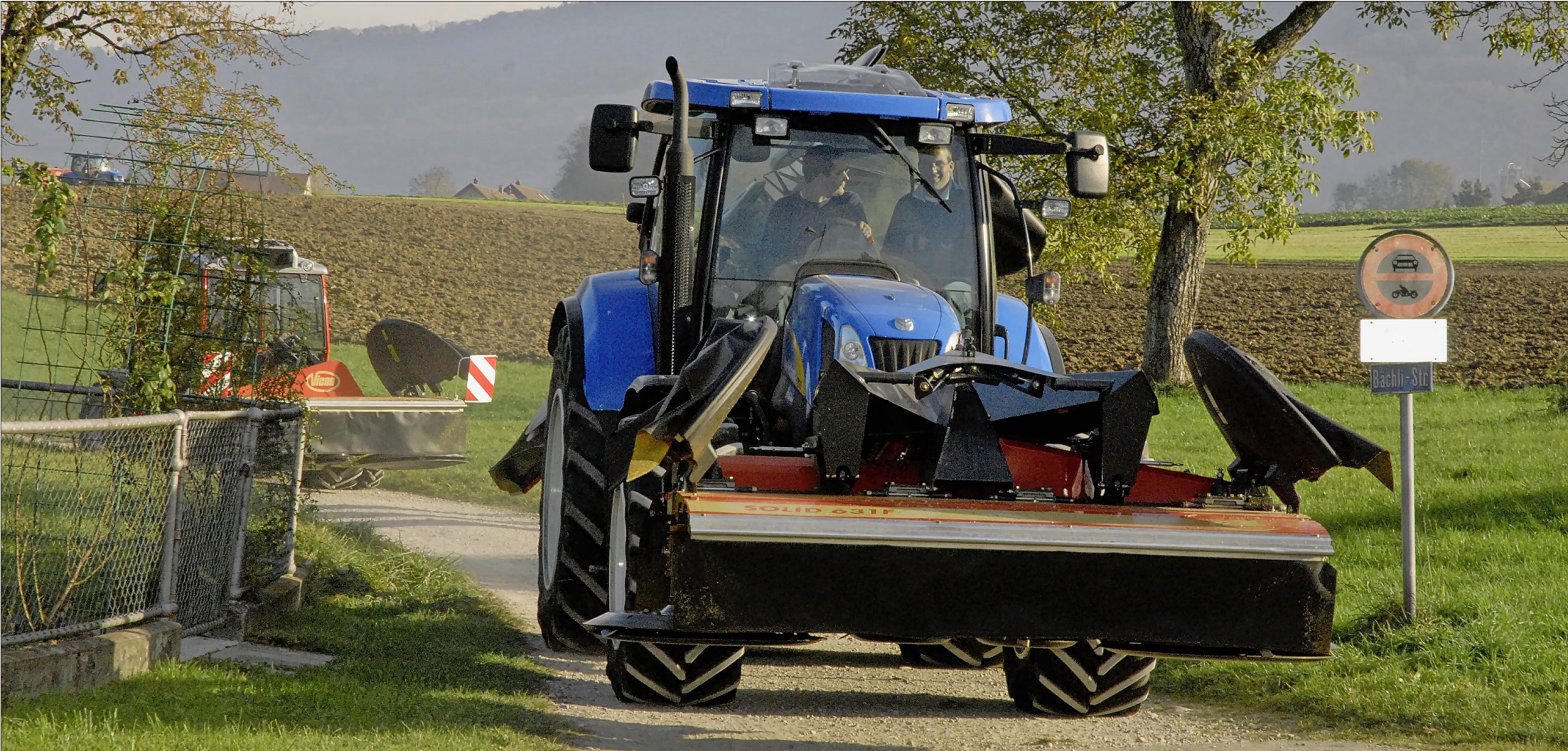
Anbaugeräte dürfen in der Schweiz maximal 3,5 Meter breit sein in Transportposition auf der Strasse. (Bilder: röt)
