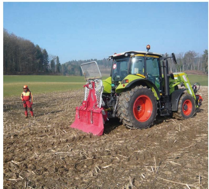
Traktoren müssen mit einer Sicherheitscabine ausgerüstet sein. Die Seilwinde benötigt ein Heckschutzgitter oder eine Heckschutzscheibe aus Sicherheitsglas und die Bedienung muss über eine «Totmannschaltung» mit Notstopp erfolgen. Mit der Funkbedienung kann die Seilwinde von einem sicheren Standort aus betätigt werden.
