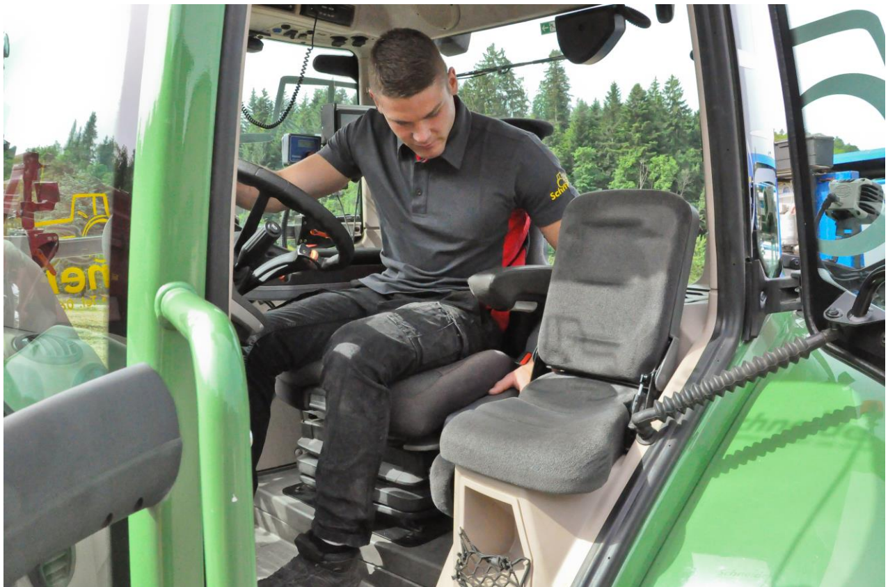
Der Fahrersitz muss insbesondere vor langen Fahrten gut auf die Person eingestellt werden.
