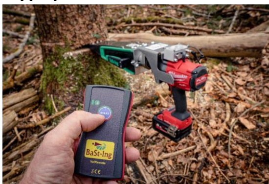
Les aides à l'abattage télécommandées peuvent être utilisées à une distance sûre et réduisent donc fortement le risque d'accident. (Photo : BaSt-Ing)
