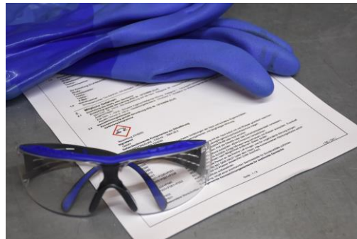
Sicherheitsdatenblätter geben Auskunft zu Gefahren, erforderlicher PSA und weiteren Schutzmassnahmen (Bild: BUL)
