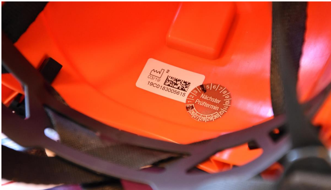
Als Bestandteil einer Persönlichen Schutzausrüstung gegen Absturz (PSAgA) muss auch ein Helm regelmässig durch eine fachkundige Person geprüft werden.
