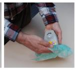
Nach Gebrauch den Partikelfilter entfernen. Den Aktivkohlefilter mit einem feuchten Tuch aussen Reinigen. **Achtung: Filter niemals mit Druckluft ausblasen!**
