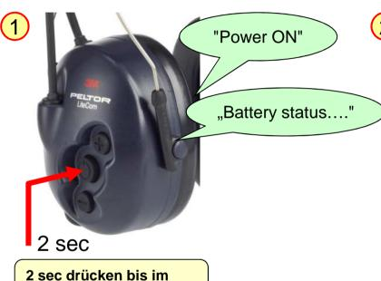
Nach "Power ON" ermittelt das Gerät den Ladezustand der Batterie
